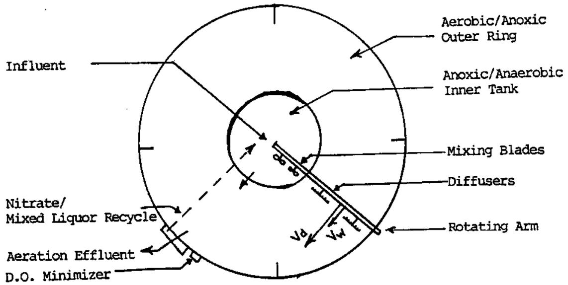
Figure 25. Schematic of Schreiber Counter Current Diffuser System<sup>TM</sup>
